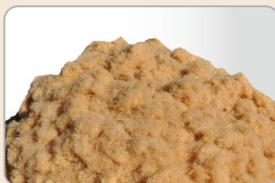
GUTEX Thermofibre® состоит из тонких не связанных между собой древесных волокон сосны и ели Шварцвальда. За счет низкого коэффициента теплопроводности значительно снижаются теплопотери. Великолепная защита от холода зимой позволит существенно сократить расходы на отопление. Диффузно-открытые древесные волокна способствуют созданию приятного и здорового микроклимата.
