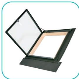
Предусмотрено боковое открывание (правое или левое) на угол до 90°. Установленный ограничитель фиксирует и удерживает створку в трех положениях проветривания. В нижней части окна-люка расположен профиль, предохраняющий оконную коробку от повреждений, а также обеспечивающий удобный выход на крышу.
