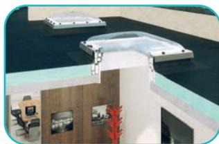
Конструкция окна представляет собой антивандальный морозостойкий стеклопакет P2 и купол из поликарбоната, стойкого к воздействию атмосферных явлений и механических повреждений. Купол может быть прозрачным (D\_C-C) или матовым (D\_C-M). Купол изготавливается с двумя типами стеклопакетов: с антивандальным однокамерным стеклопакетом P2 либо с трехкамерным стеклопакетом U8 (VSG).
