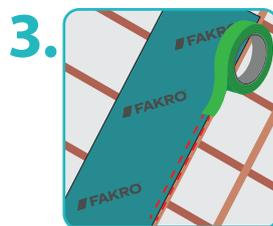
Примыкание пленок к строительным конструкциям.
