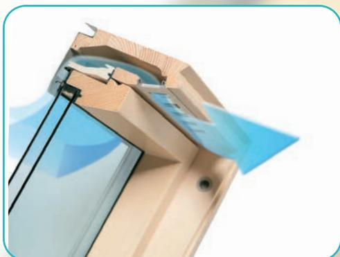
Поток воздуха регулируется вручную. Пропускная способность вентклапана V10 до 9 м<sup>3</sup>/час, вентклапана V22 до 31 м<sup>3</sup>/час при разнице давлений 10 Па. Удобная задвижка позволяет вручную регулировать (уменьшать или увеличивать) поток свежего воздуха. Размер впускных отверстий и дополнительный фильтр исключают возможность проникновения в комнату пыли и насекомых. Вентклапаны V10 и V22 могут использоваться только в помещениях с исправной вентиляцией.
