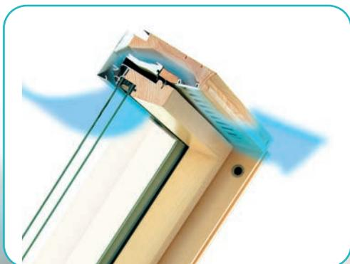
V40P - модель вентиляционного клапана с пропускной способностью до 49 м<sup>3</sup>/ч, которая позволяет оптимизировать приток свежего воздуха в помещение за счет автоматического частичного закрывания в случае высокой разницы давлений. Благодаря лабиринтообразному строению клапана перемешивание холодного воздуха, поступающего с улицы, с теплым воздухом происходит внутри вентклапана, что предотвращает образование конденсата на внутренней стороне стеклопакета.
