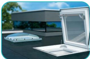
Окно DRC обеспечивает свободный выход на плоскую крышу. Специальные петли и удобная ручка позволяют открывать створку люка до 60-80°, в зависимости от размера окна. Газовые пружины облегчают управление створкой, а также удерживают ее в зафиксированном положении, защищая от случайного закрывания. На профилях люка установлены противоскользящие накладки.
