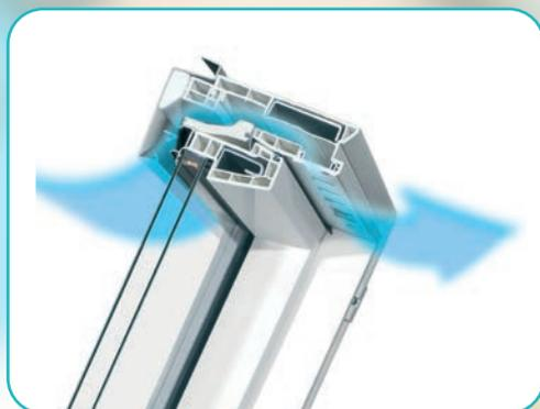
Вентиляционные клапаны V35, V40 располагаются в неподвижной части рамы и имеют лабиринтообразную форму, где поток воздуха регулируется вручную. В помещение воздух попадает уже теплым. Пропускная способность вентклапана V35 до 41 м<sup>3</sup>/час, V40 до 49 м<sup>3</sup>/час при разнице давлений 10 Па. При неправильной работе вентиляции в здании вентиляционный клапан работает на отток, выводя наружу использованный влажный воздух из помещения.
