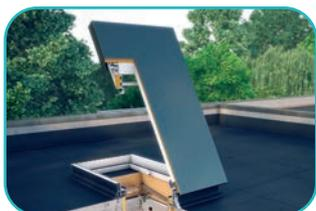
Люк DRL предназначен для удобного и безопасного выхода на крышу. Обладает высокими параметрами теплоизоляции и герметичности (толщина утеплителя крышки люка - 44 мм). Люк DRL изготавливается из многокамерного профиля ПВХ (цвет с внешней стороны RAL 7022) и не имеет стеклопакета. Благодаря газовым пружинам створка открывается на угол до 60° и фиксируется.
