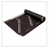
Пленка Wallint® T100 SK² укладывается во внешней зоне на сплошной настил под накладной изоляцией кровли. Двойная клеящая полоса обеспечивает воздухонепроницаемое склеивание. Все незакрытые нахлесты склеиваются с помощью Permo® TR plus.
