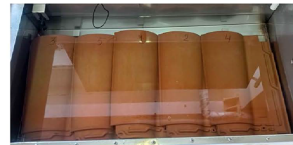
Рисунок - Образцы после 250 циклов попеременного замораживания и оттаивания
