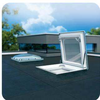
Термоизоляционное окно DRC обеспечивает свободный выход на плоскую крышу. Специальные петли и удобная ручка позволяют открывать створку люка до 80° (в размерах 90x120 и 120x120 створка открывается на 60°), газовые амортизаторы облегчают управление створкой и удерживают ее в зафиксированном положении. Коробка окна-люка изготовлена из утепленного многокамерного профиля ПВХ. Окно оборудовано антивандальным морозостойким стеклопакетом P2 и куполом (прозрачным или матовым).
