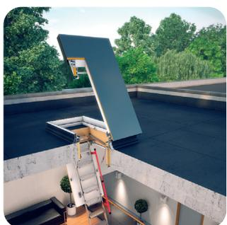
Готовое решение для обустройства плоской кровли - возможна установка люка DRL и металлической лестницы LML Lux в единую конструкцию для комфортного и безопасного выхода на плоскую кровлю и ее обслуживания. Люк обладает высокими параметрами теплоизоляции и герметичности (толщина утеплителя – 44 мм), изготавливается из многокамерного профиля ПВХ без стеклопакета, устойчив к механическим повреждениям. Благодаря газовым пружинам створка открывается на угол до 60° и фиксируется.
