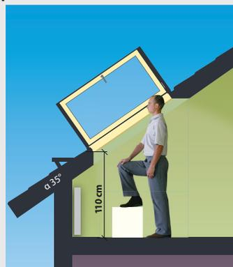
Распашное термоизоляционное окно объединяет в себе преимущества окна для крыши и выхода на крышу.
