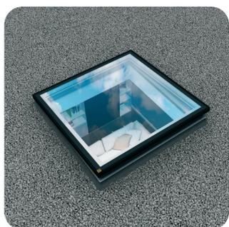
Окно D\_G сочетает в себе лаконичный дизайн и увеличенные параметры теплоизоляции. Рама изготовлена из многокамерного профиля ПВХ, заполненного утеплителем. Специальная технология отвода дождевой воды от окна обеспечивает герметичность установки. Наружное стекло – закаленное, внутреннее – антивандальное класса P2A, в случае повреждения внутреннего стекла, осколки не рассыпаются, а остаются приклеенными к пленке, что обеспечивает дополнительную безопасность.
