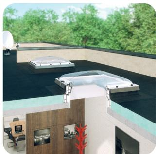
Окно изготовлено из многокамерного профиля ПВХ, заполненного утеплителем. Конструкция окна представляет собой антивандальный морозостойкий стеклопакет P2 и купол из поликарбоната, устойчивый к механическим повреждениям и воздействию атмосферных осадков и УФ лучей. Купол может быть прозрачным (D\_C-C) или матовым (D\_C-M). Возможно изготовление окна с трехкамерным стеклопакетом U8, такие окна можно применять в пассивном строительстве.
