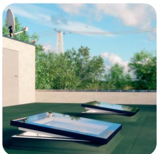
Окно изготовлено из многокамерного профиля ПВХ, заполненного утеплителем. Стеклопакет в окнах вклеен в профиль, что обеспечивает высокую прочность и стильный дизайн. Суперэнергоэффективный двухкамерный стеклопакет DU6 с внутренним ламинированным стеклом обеспечивает высокие параметры теплоизоляции и герметичности. Возможно изготовление окон в версии ClourLine, благодаря которой наружные профили можно покрасить в любой цвет из палитры PAL Classic.
