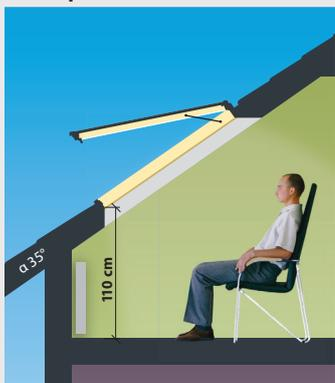
В мансардных окнах FTP-V (CH) top-hung открывание осуществляется благодаря механизму поворотных петель с верхним расположением. Створка открывается на 30° с помощью газовых пружин. Управление створкой осуществляется ручкой, расположенной в нижней части окна.
