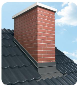
**GZK-AV** – для герметичного соединения дымовой трубы с кровлей. Подходит к трубам шириной до 95 см и высотой до 180 см (размер измеряется по поверхности крыши). Верхний и нижний элементы регулируются, а боковые - подрезаются. Установка в кровле от 15° до 60°.
