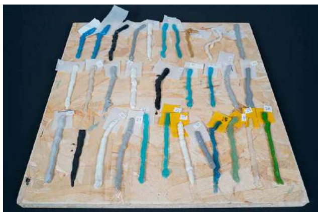
Серия испытаний по оценке адгезии, сцепления и эластичности различных клеев и герметиков.
